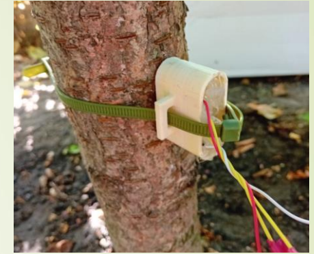
Расположение нагревателя и термопар датчика в ксилеме штамба дерева
